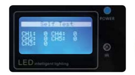
In kurzer Zeit wird jeder Farbkanal nacheinander auf volle Leistung gebracht und anschließend wieder auf Null gedimmt. Die angeschlossenen Lampen sollten einen entsprechenden Farbwechsel in schneller Folge zeigen.
