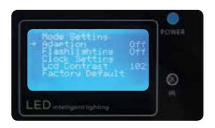
Der Menüpunkt "Adaption" simuliert einen Sonnenauf- und untergang. Wenn Sie diesen Punkt auf "On" schalten, wird die LED-Lampe, auch im Instant-Modus, Ihre Leistung langsam ansteigen lassen. Schalten Sie diesen Punkt auf "Off", leuchtet Sie direkt mit der definierten Stärke, sobald Sie mit Strom versorgt wird.
